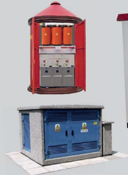
Все подстанции серии e.CTS изготовлены из высококачественного бетона марки В-35. Корпус подстанции состоит из надземной части и кабельного отсека, которые являются одним компактным сооружением. Все элементы здания выполнены из негорючих материалов. Маслосборники под трансформатором рассчитаны на 100% содержание масла установленных трансформаторов (в случае применения масляных трансформаторов).
