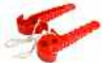
Используется во время монтажных работ для удобства присоединения ответвленной линии к магистральной с помощью присоединительных прокалывающих зажимов. Клин устанавливается в жгут провода СИП для извлечения одной жилы из провода.
