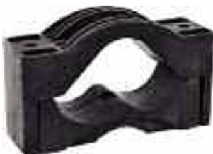
Кабельные хомуты Triple предназначены для крепления трех одножильных и многожильных проводов (прокладка в треугольник). Для кабелей низкого, высокого и среднего напряжения с диаметром 27-150 мм.
