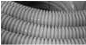
Труба гофрированная с металлической протяжкой предназначена для защиты проводов и кабелей от механических повреждений и попадания грязи. Изготовлена из ПВХ не поддерживающего горения.
