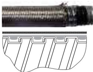
Оболочка: металлическая оплетка, придающая высокую механическую прочность. Полиэтиленовая пленка предназначена для механической защиты ПВХ изоляции от трения с оплеткой. ПВХ трубка служит для герметичности металлорукава.
