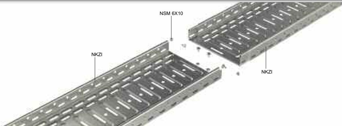
Лоток для кабеля NKZI с сохранением функциональности во время пожара должен быть изготовлен из листа толщиной 0,7 или 1,25 мм. Соединение кабельного лотка NKZI проводится с помощью интегрированного соединителя, который является составной частью лотка, и с помощью болтов NSM 6X10 или же болтов NSM 6X10-GMT. Для сохранения прочности несущей трассы при очень тяжелых условиях пожара необходимо данные болты установить во все отверстия в местах соединения лотков.
